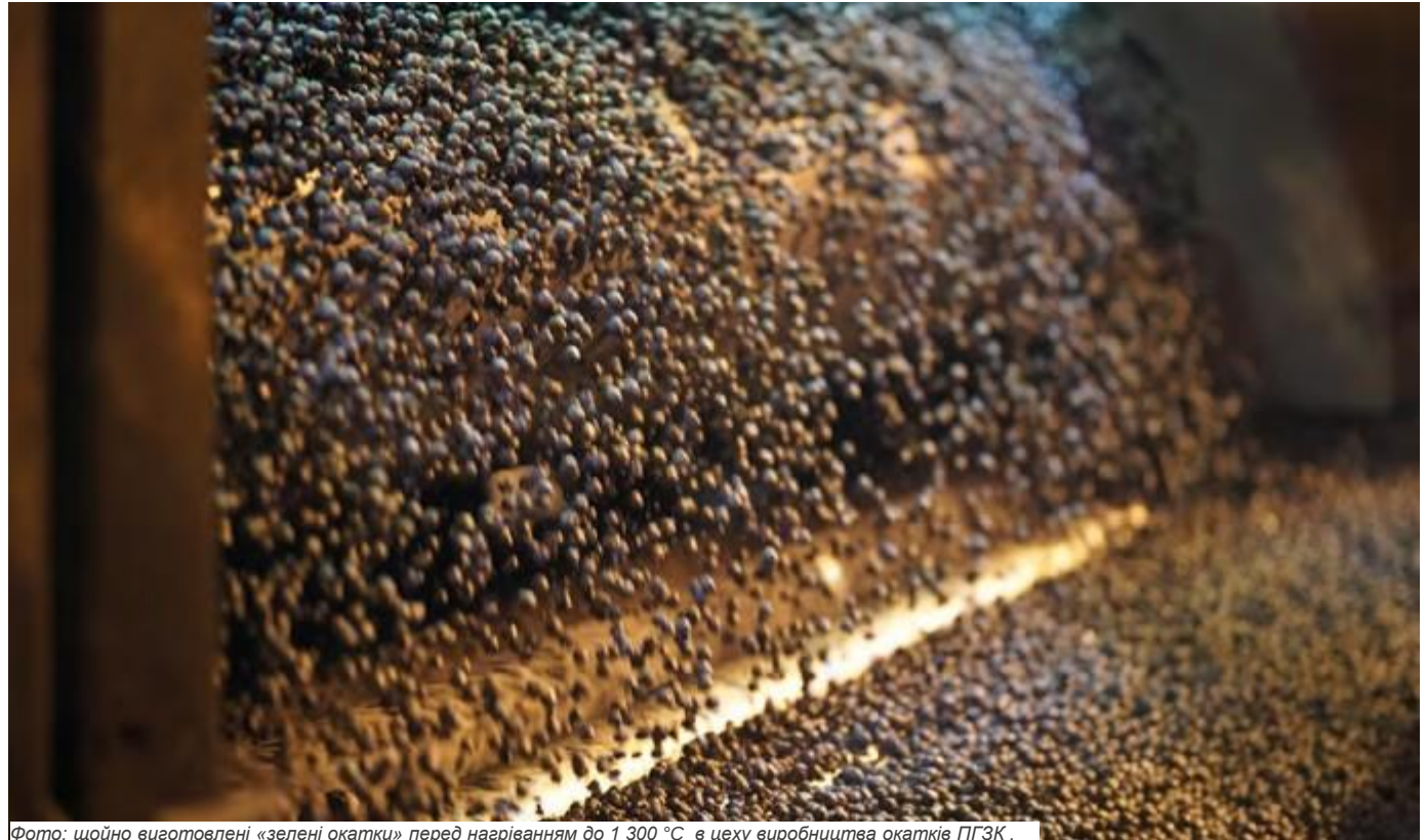
Фото: щойно виготовлені «зелені окатки» перед нагріванням до 1 300 °C в цеху виробництва окатків ПГЗК.
